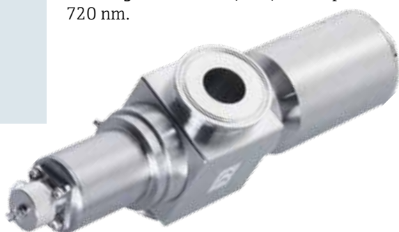
Sensore di misura modello OUSAF12 a tecnologia fotometrica ad assorbimento di luce con filtro ottico a 880nm e sistema di taratura integrato easykal certificato NIST.
