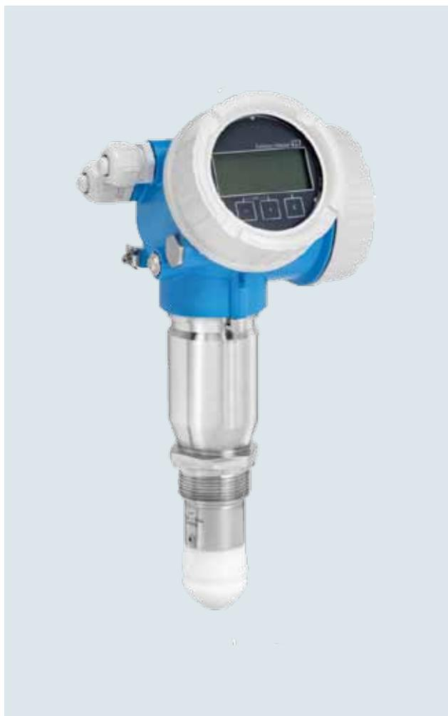
Ideale a questo scopo si è rivelato il radar a spazio aperto **Micropilot FMR60** di Endress+Hauser. L'emissione ad alta frequenza in banda W ad 80 GHz con propagazione in modulazione di frequenza FMCW, consente di gestire efficacemente misure in serbatoi di ridotte dimensioni senza zone cieche vicino all'attacco al processo
