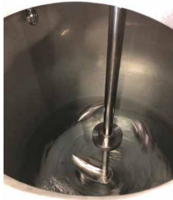
Visione interna del serbatoio con agitatore in movimento
