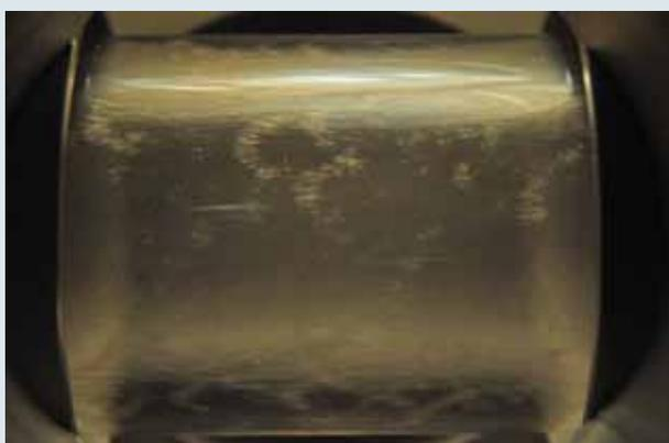
**Qualità del vapore 80%, vapore umido con presenza di condensa**
